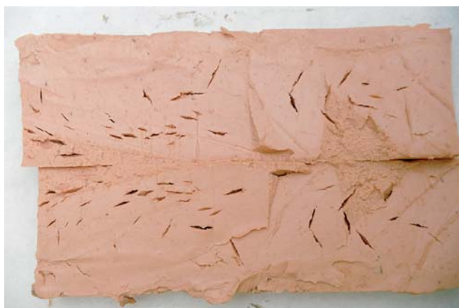
Imagen 30a. Rotura de la estructura interna de un paté en forma de pequeños cortes perpendiculares al eje del bote por descompresión excesivamente rápida.
