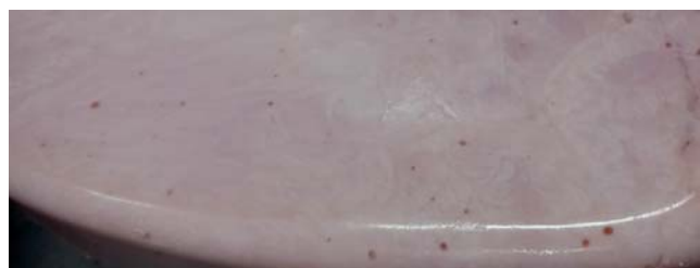
Imagen 30g. Pequeños agujeros externos producidos por insuficiente vacío.
