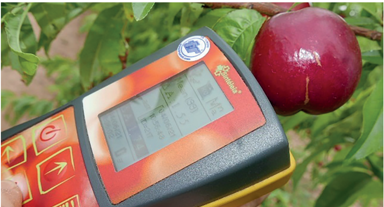
Figura 3. Medida del índice de clorofila a una semana antes de la cosecha.
