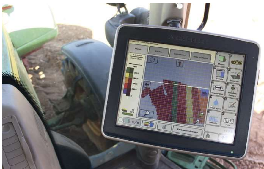
FOTO 2 Pantalla del dispositivo instalado en la máquina para visualizar el mapa de prescripción y la dosis a aplicar
