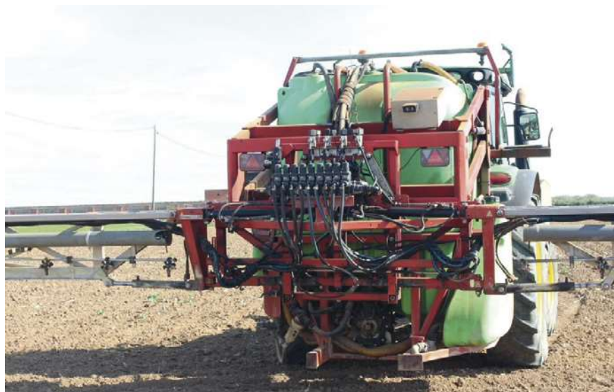
FOTO 3 Ejemplo de máquina de aplicación variable de fertilizantes minerales de tipo líquido.
