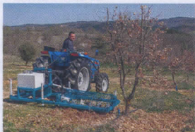
Scarificateur déporté Fraise rotative à dents piocheuses Système breveté
