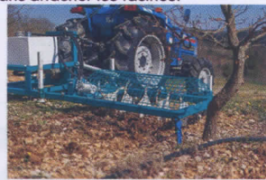
Scarificateur déporté Fraise rotative à dents piocheuses Système breveté
