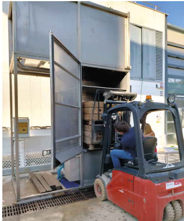
FIGURA 5 Colocación de palots de pera Conferencia en un equipo de hidrogenfriamiento de la empresa INDUSTRIAL LLEIDATANA DEL FRED S.L.U.
