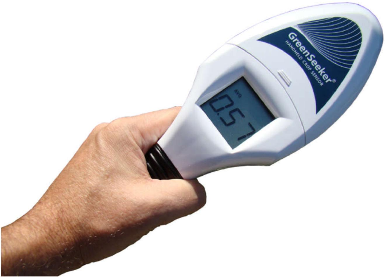
*Figura 3. Ejemplo de detector de NDVI manual.*
