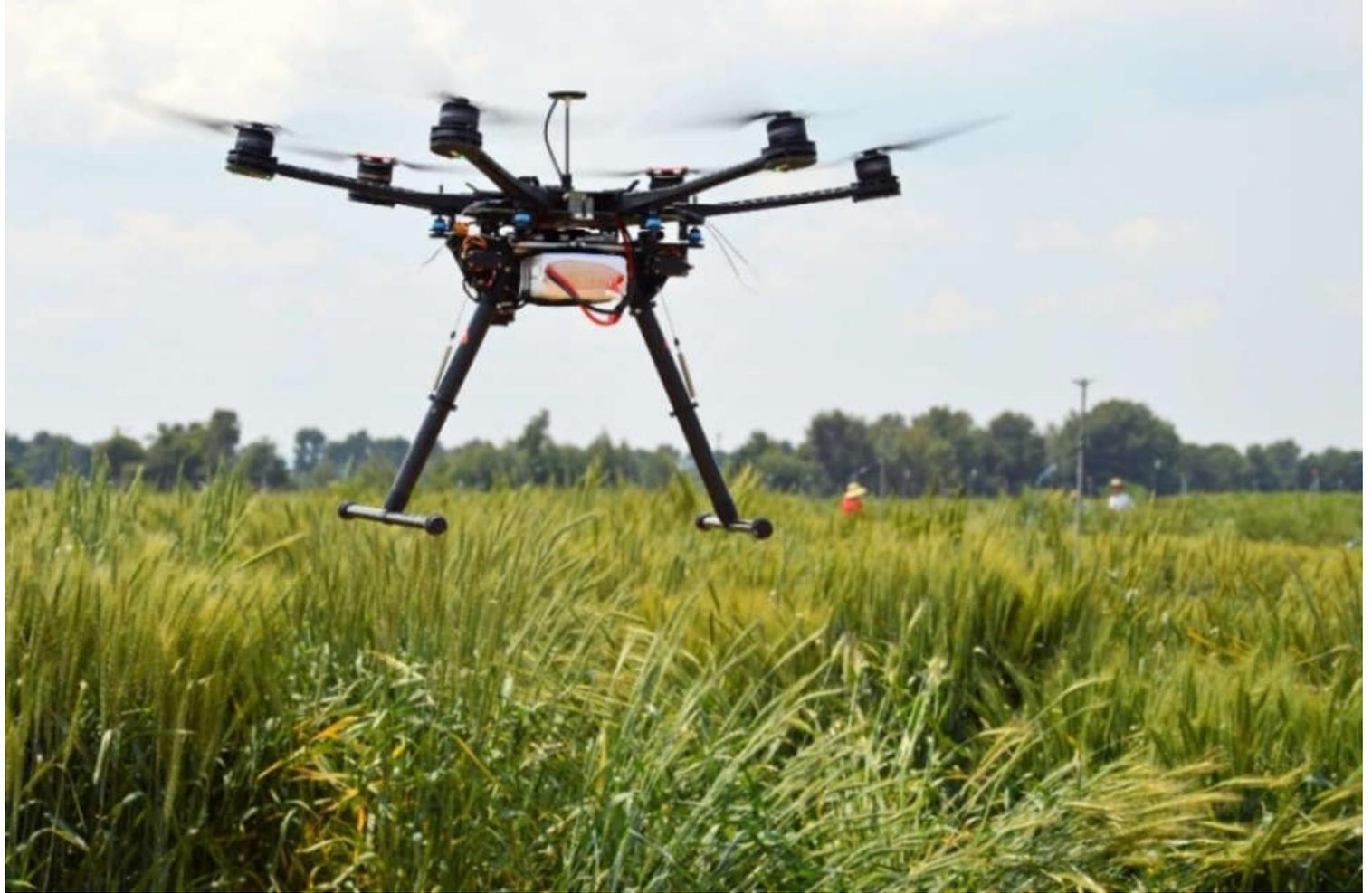
*Figura 4. Dron con cámara para detectar NDVI en campo.*
