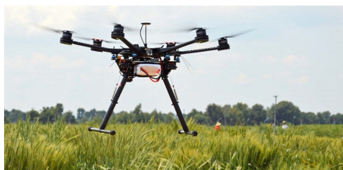
Figura 4. Drone com câmara para detetar NDVI no campo
