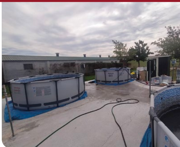
Imagen 1. Planta piloto de acidificación de purines del proyecto ACIDEMO.
