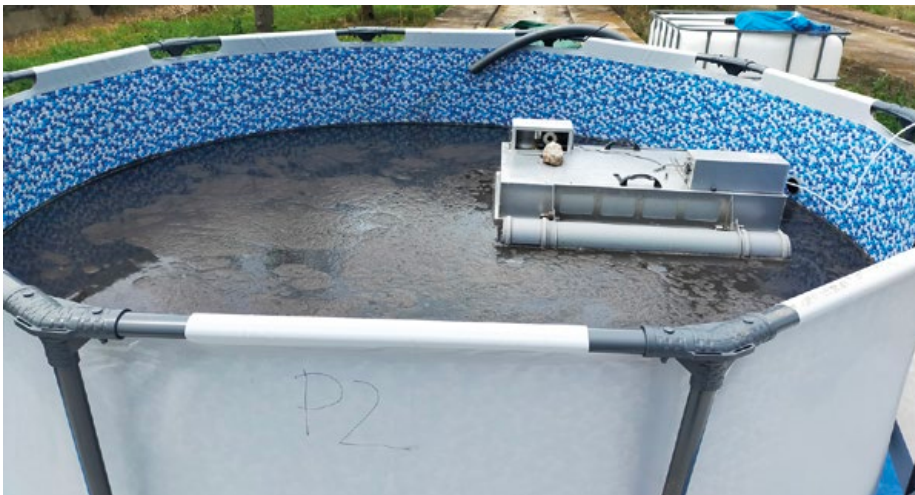
Imagen 2. Medición de las emisiones en la balsa acidificada mediante campana dinámica tipo Lindvall.
